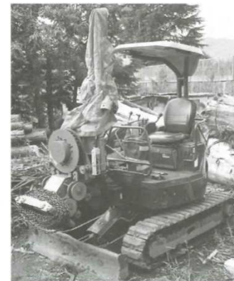
チェーン集材の要、巻取装置取付けた移動車
